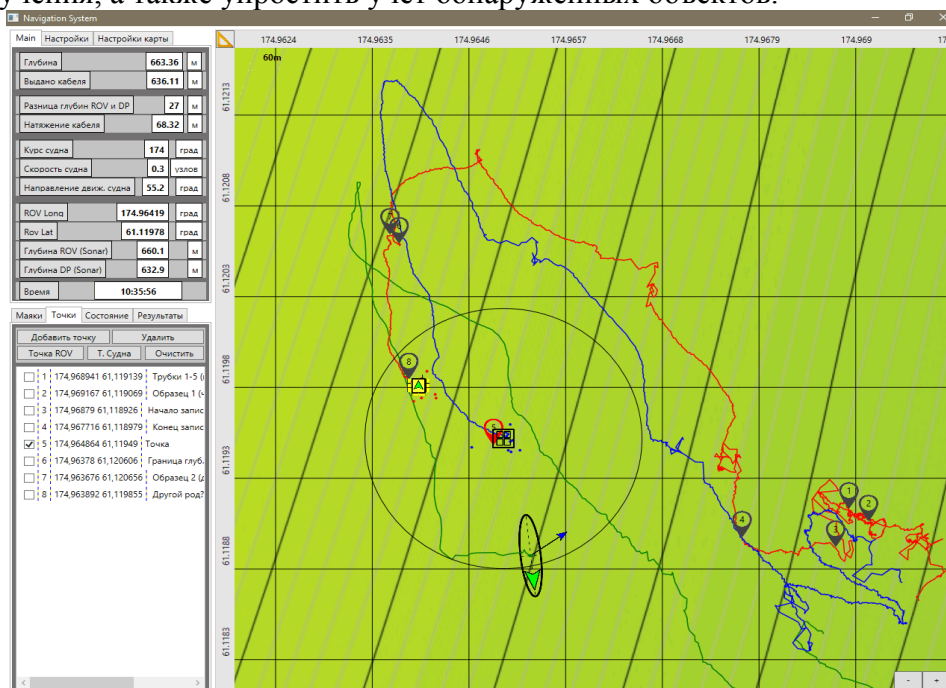
Рисунок 42 - Графический интерфейс системы интеллектуальной поддержки деятельности операторов ТНПА в процессе выполнения подводной операции
